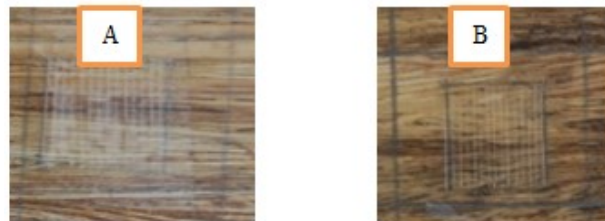
Gambar 4. Penampilan uji cross cut pada permukaan papan zephyr, saat tertutup dengan tape (A) dan (B) setelah tape dilepas
