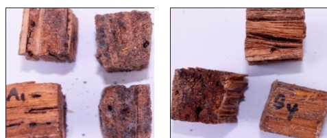
Gambar 6. Keragaan hasil serangan rayap tanah berdasarkan jenis perekat A(PFF) dan B(UFF)
