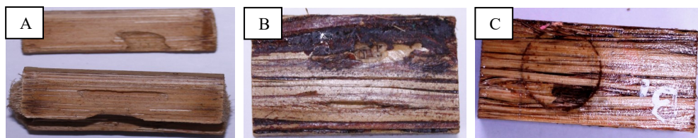
Gambar 5. Keragaan uji serangan rayap cryptotermes spp pada pelepah sawit (A), papan zephyr tanpa lapisan finishing (B) dan papan zephyr dengan lapisan finishing (C)
