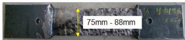
Gambar 1. Korosi spesimen dengan permukaan ireguler
