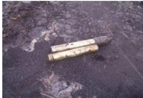
Gambar 2. Alat untuk Hand boring
