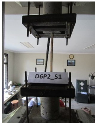
Gambar 7. Pengujian kuat cabut
