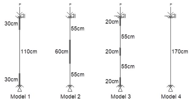
Gambar 5. Sketsa penempatan pengaku struktur benda uji
